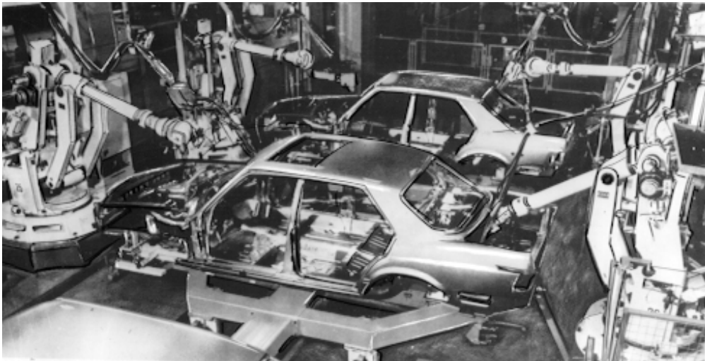
Рис.9.8. Участок точечной сварки роботами кузовов автомобилей.
