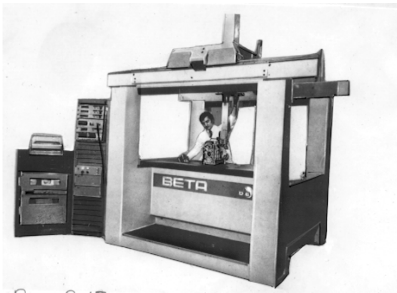
Рис.9.12. Измерительная машина фирмы DEА (Италия).
