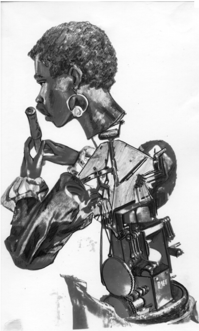
Рис.1.1. Механический писец Анри Дро.
