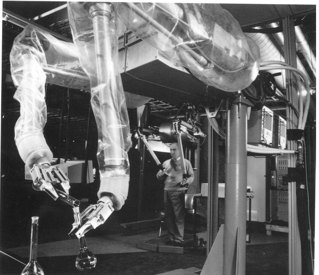
Рис.1.4. Копирующий манипулятор Маскот фирмы «Телеробот» (Италия).
