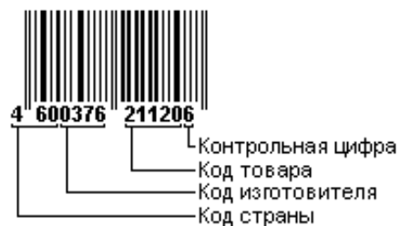
Рис. 2.4. Состав кода EAN-13
