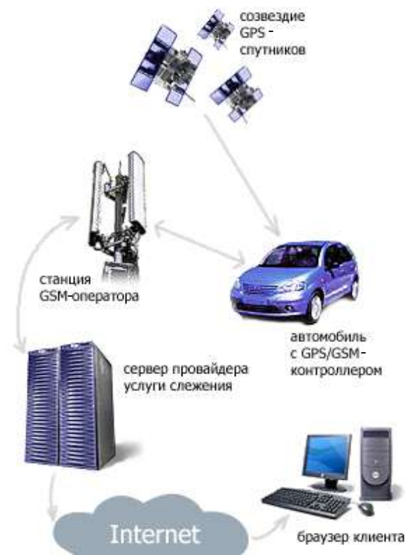
Рис. 5.8. Схема доставки данных о местоположении автомобиля с помощью сотовой связи через Интернет
