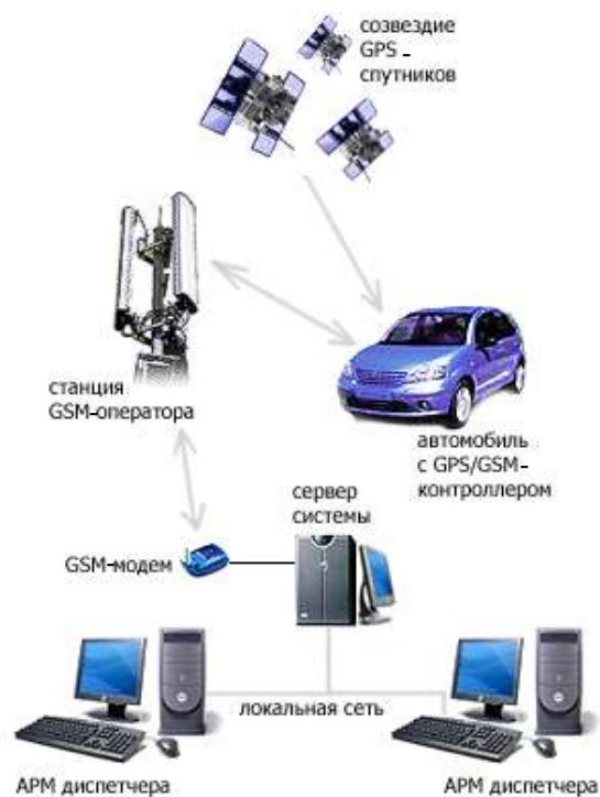
Рис. 5.7. Схема доставки данных о местоположении автомобиля с помощью сотовой связи и собственного диспетчерского пункта
