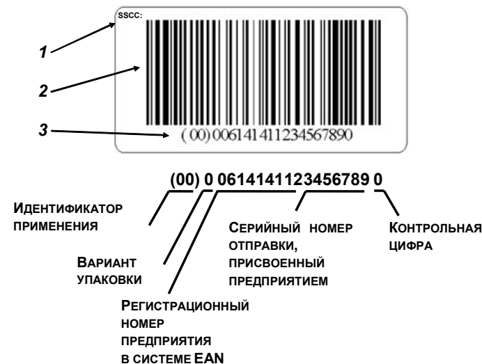
Рис. 2.8. Основная этикетка, использующая уникальный идентификатор транспортируемой единицы EAN/UCC-128: 1 – заголовок поля; 2 – штрих-код уникального идентификатора транспортируемой единицы; 3 – визуальное представление штрих-кода
