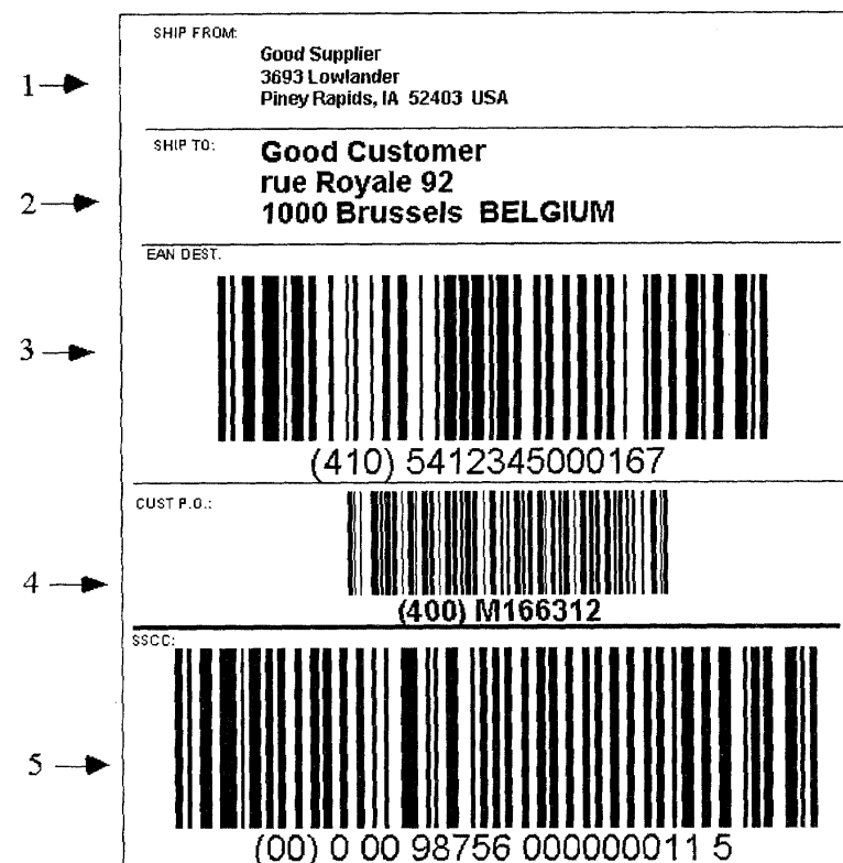
Рис. 2.10. Основная этикетка, содержащая уникальный идентификатор транспортируемой единицы в символике UCC/EAN и ссылки к базам данных перевозчика и заказчика:
