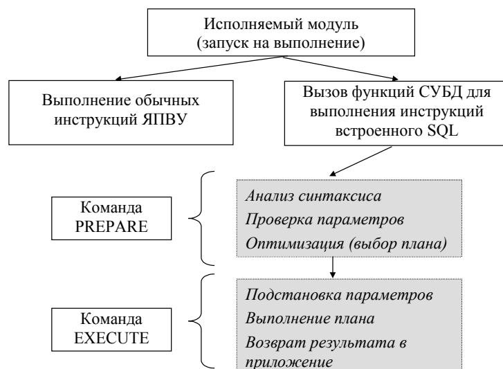
Рис. 53. Схема выполнения программы со встроенными инструкциями динамического SQL с применением двухэтапной схемы
